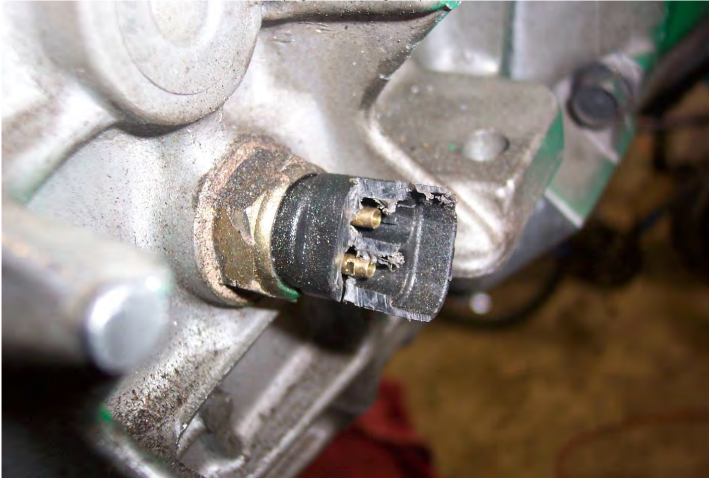
Backup switch trimmed.JPG
